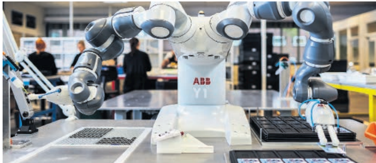
YuMi im Einsatz: Der kollaborative Zweiarm-Roboter von ABB.
